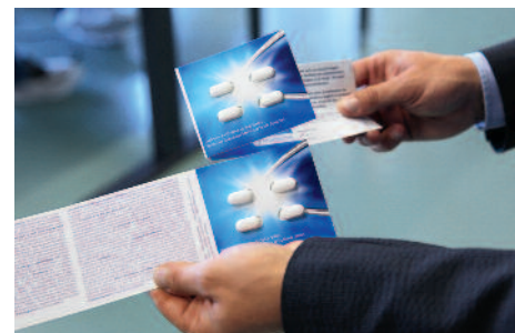
Beispiel Pharmaverpackung: Diese Musterpackung wird aus Blister und Kartonzuschnitt manuell zusammengefügt.
